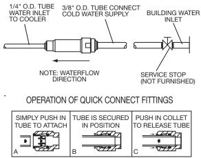
PUSHING TUBE IN BEFORE PULLING IT OUT HELPS TO RELEASE TUBE
